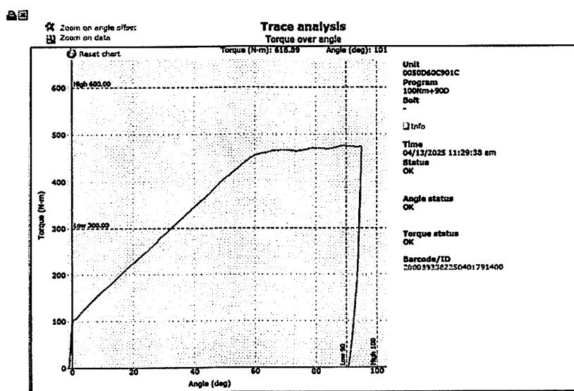
6.1.6.3 软件能够读取招标方的扫码枪扫描的产品序列号，将拧紧力、曲线等结果记录在对应的产品序列号，便于查询；同时软件支持汇总、查询拧紧信息，通过查询界面可以快速调取拧紧结果，查询拧紧过程信息；查询界面可参考以下界面设计：
